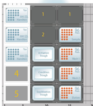
使用 300 µL MicroSep® IMCStips 进行脱盐纯化的工作台布局
