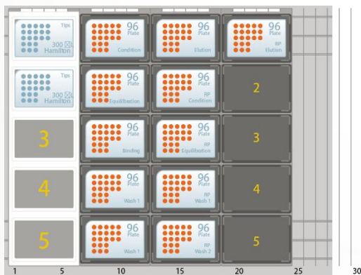
Hamilton Microlab STAR 移液工作站进行 Protein A/G 亲和纯化的工作台布局
